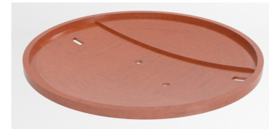
Ilustración 148: Cuenco superior visto desde arriba. Aquí podemos ver el rebaje en el cual se adhiere el Enganche.
