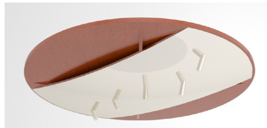
Ilustración 135: Unión de Enganche y Tapa vista desde abajo.
