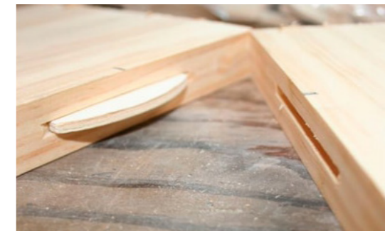
Ilustración 144: Unión por galletas.
