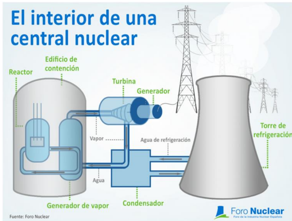
Figura 5. Esquema básico de una central nuclear (Foro de la Industria Nuclear Española, 2023)
