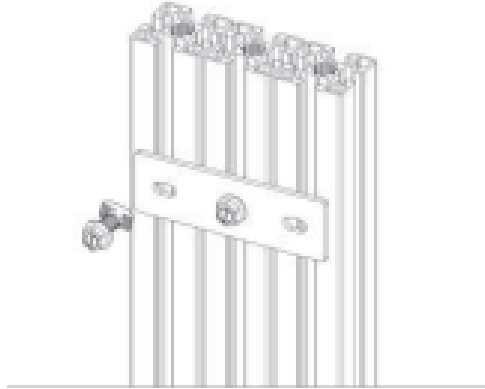
Figura 29. Unión entre perfiles paralelos [4]
