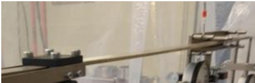
Figura 11. Pletina de acero fijada en banco de ensayo
