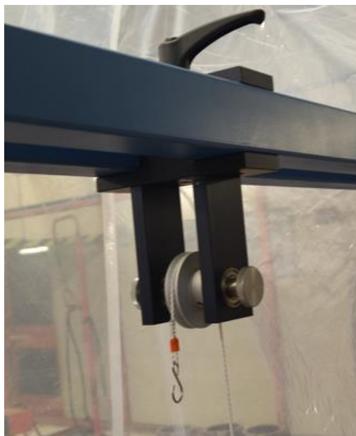
Figura 68. Modelo físico en el Laboratorio de útil para posicionar polea.
