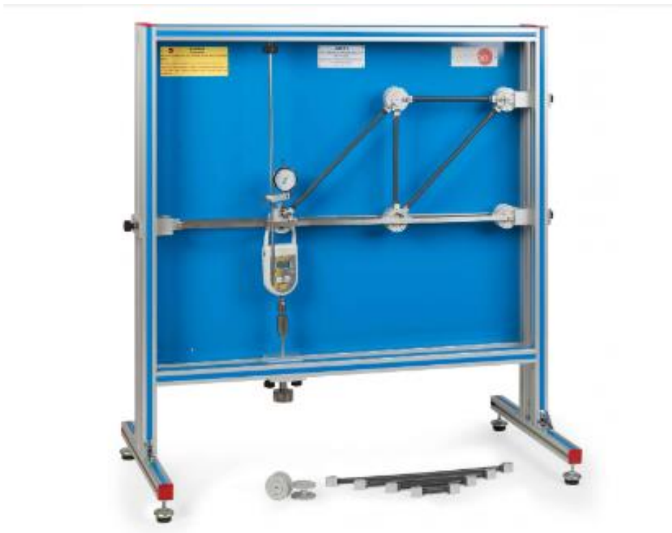
Figura 1. EQUIPO PARA ESTUDIO DE DEFORMACIÓN DE CELOSIAS, EDIBON [1]
