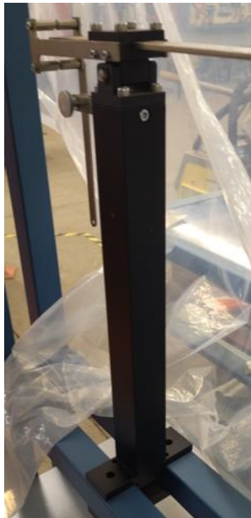
Figura 6. Soporte con caso de empotramiento de banco usado en el laboratorio.
