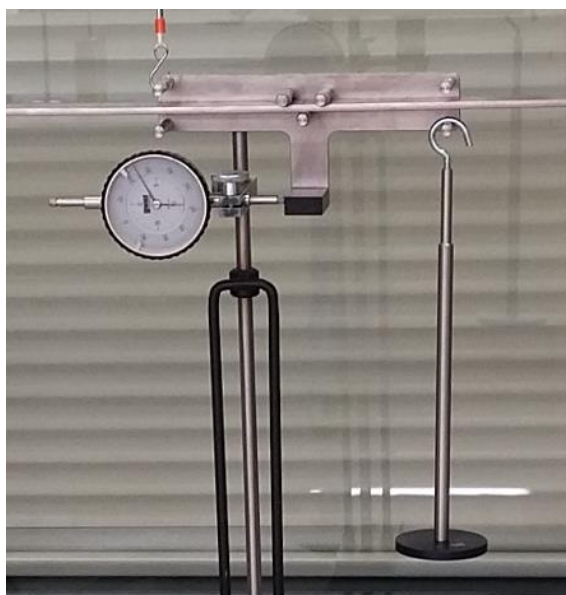
Figura 17. Útil para aplicación de momentos
