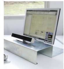
Figura 8. Dispositivo de Eye-Tracking vinculado con el ordenador.
