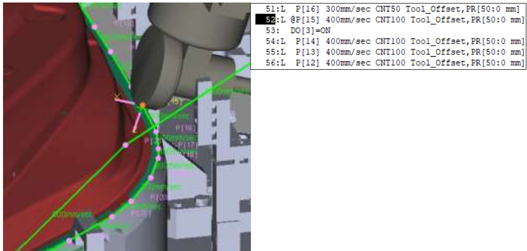
Figura 270. Robot A desbloquea el movimiento del robot C
