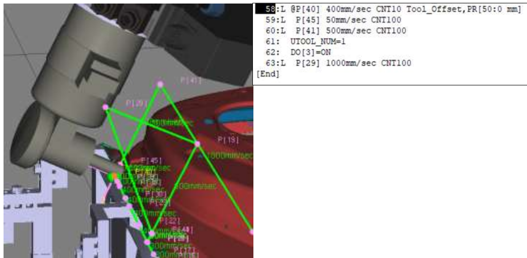
Figura 347. Robot A, finalización del proceso y envío de señal a los otros dos robots
