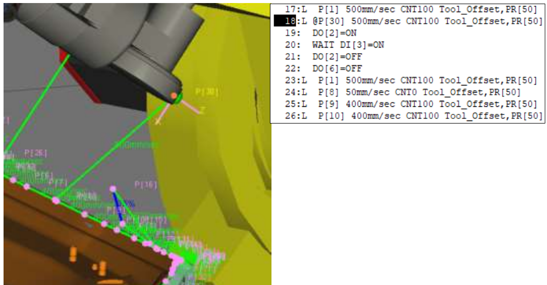
Figura 454. Robot B, envío de señal de movimiento al robot A y espera a señal de movimiento de A
