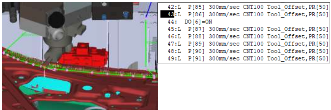
Figura 313. Robot B envía señal de movimiento al robot C
