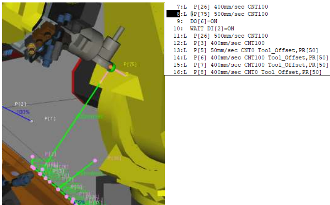
Figura 453. Robot B, envío de señal de movimiento al robot C y espera de la señal de movimiento de C
