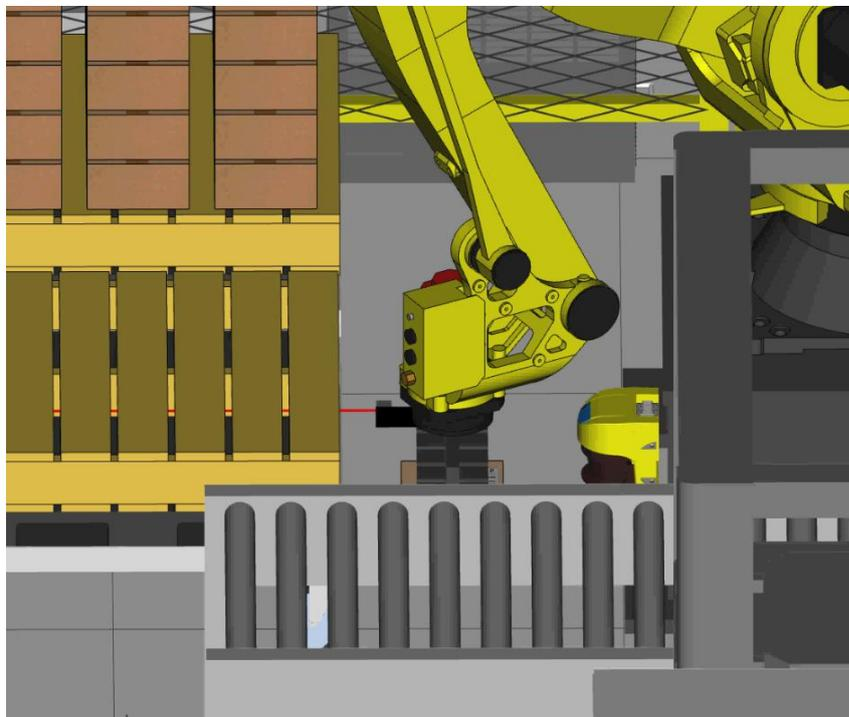
*Figura 67 Robot R5 en ciclo de medida con fotocélula detectando.*
