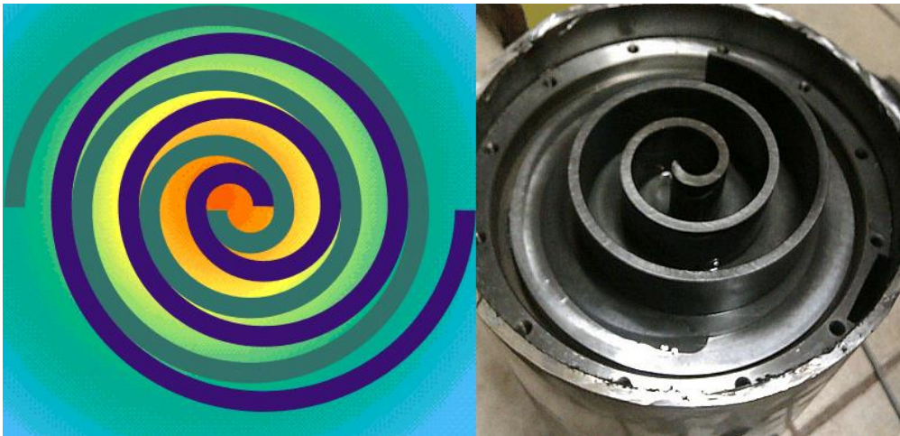
Figura 5. Esquema compresor tipo scroll. Tomado de [43]
