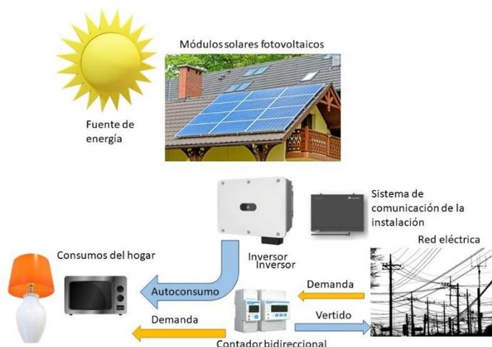
Figura 2. 1 Esquema general de una instalación solar fotovoltaica de autoconsumo
