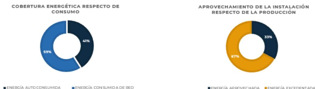
Figura 4. 8 Cobertura energética y aprovechamiento de la instalación respecto de consumo y producción respectivamente de la instalación de 160 módulos fotovoltaicos
