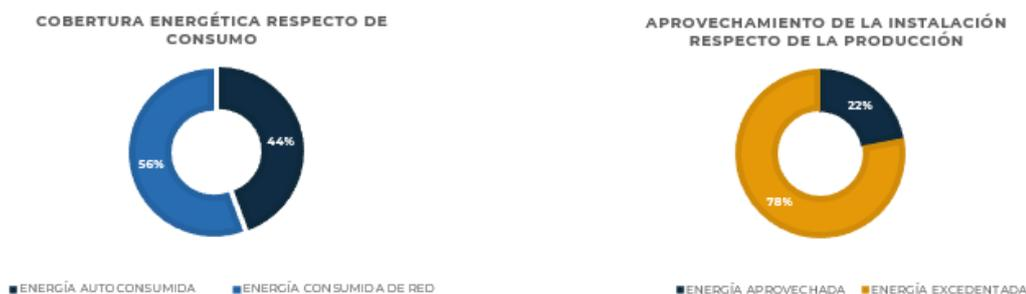
Figura 4. 7 Cobertura energética y aprovechamiento de la instalación respecto de consumo y producción respectivamente de la instalación de 258 módulos fotovoltaicos
