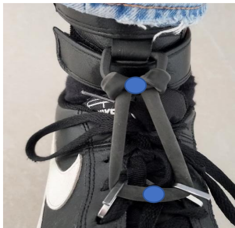
Figura 83. Localización de los sensores en la goma para analizar sus deformaciones durante la marcha.
