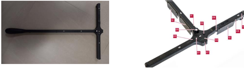
Figura 8. Active IR Wand. Izq.: banda de calibración, Drcha.: partes del calibrador [12].
