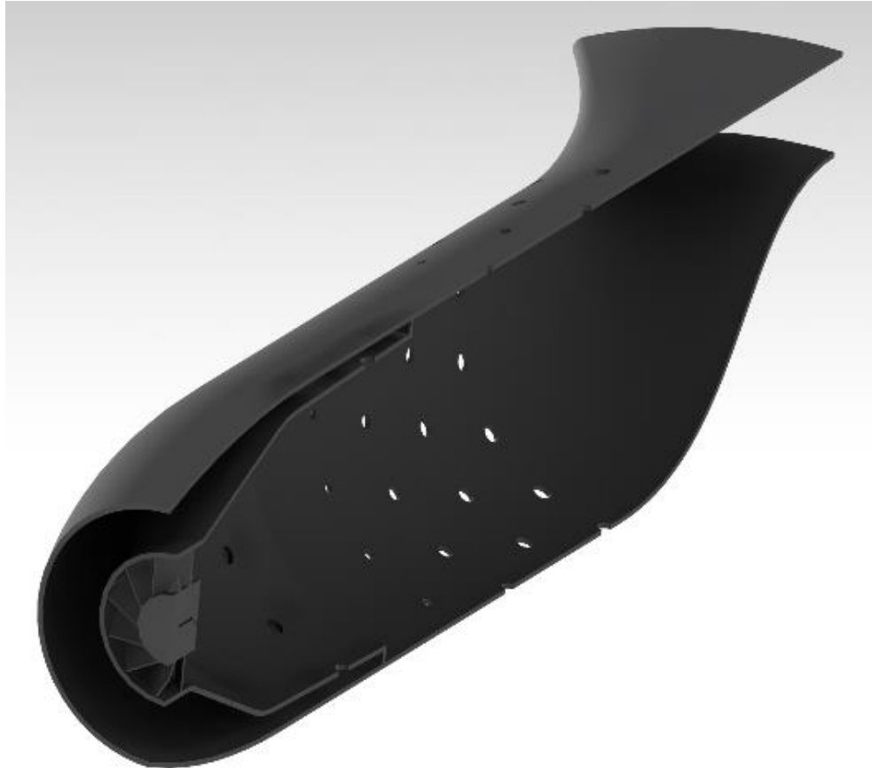
Figura 3.5 Renderizado de un corte de simetría de la cámara de combustión por difusión
