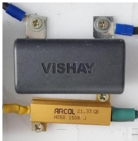
*Figura 23. Circuito amortiguador RC. Fuente propia*
