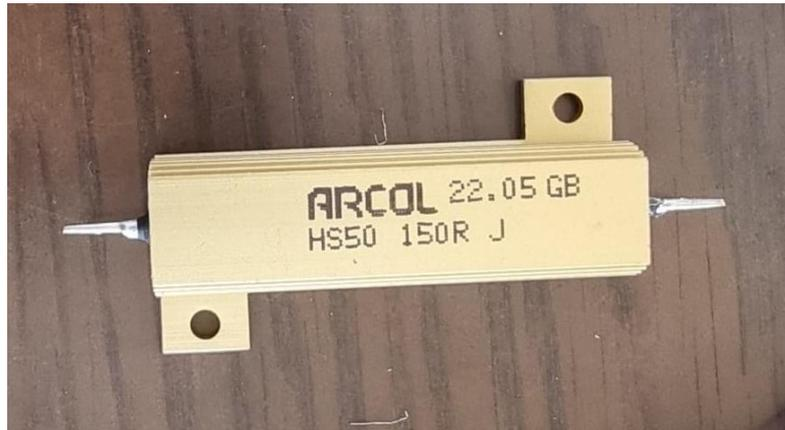
Figura 28. Resistencia bobinada. Fuente propia
