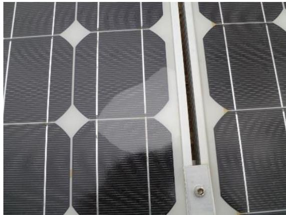
*Figura 8. Delaminación en un panel solar. Fuente [12]*
