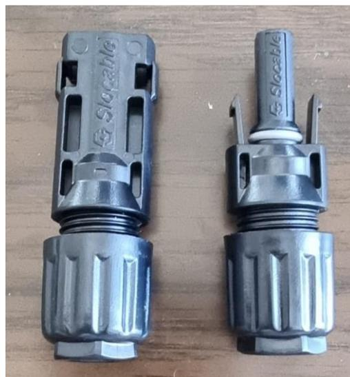
Figura 37. Conectores MC4 para panel solar. Fuente propia
