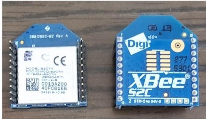
Figura 24. Módulo comunicación Xbee de Digi. Fuente propia
