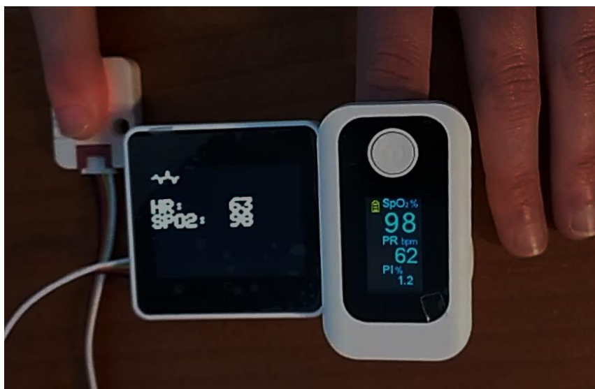
Fig 36. Registro simultáneo con oxímetro comercial y prototipo
