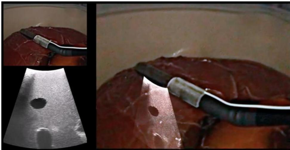
**Figura 6.** Funcionamiento del endoscopio y el ecógrafo por separado a en las dos imágenes de la izquierda. Funcionamiento del sistema combinando las imágenes del endoscopio y el ecógrafo. [27]
