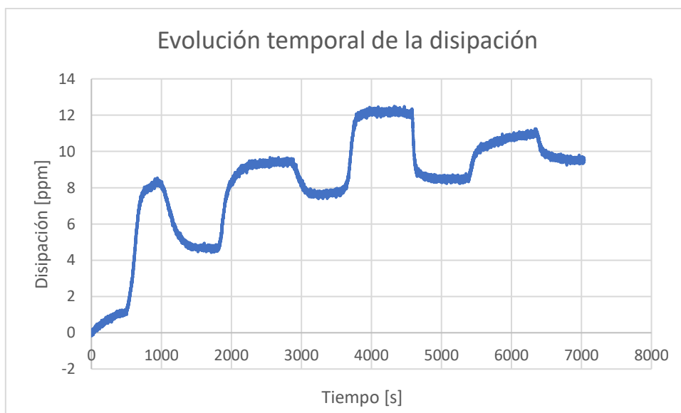
Figura 27. Evolución temporal de la disipación durante el proceso de biofuncionalización
