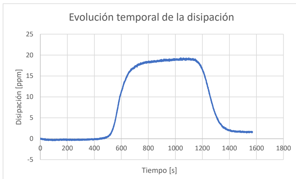
Figura 23. Evolución temporal de la disipación durante el proceso de silanización
