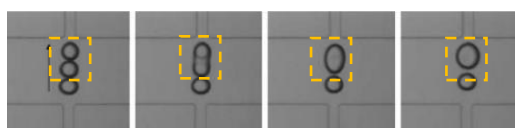
(72) Figura 12: Fusión de dos gotas en una sola.
