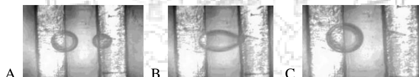
(80) Figura 14: Fusión activa de gotas empleando corrientes eléctricas.
