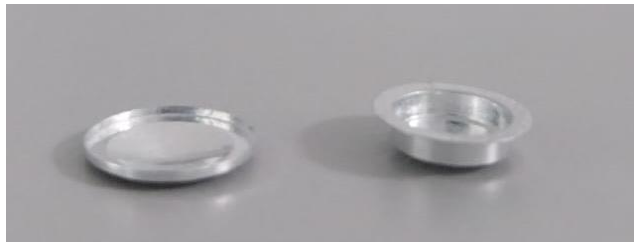
Pareja de lentes del DSC: parte superior (izquierda) y parte inferior (derecha)
