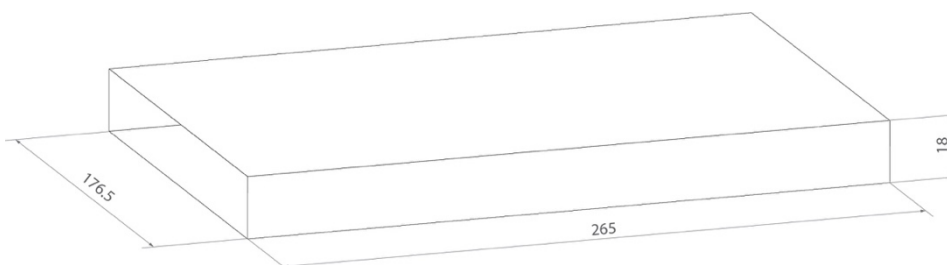
Fig. 81 Esquema de las dimensiones generales de la caja [Elab. autora]
