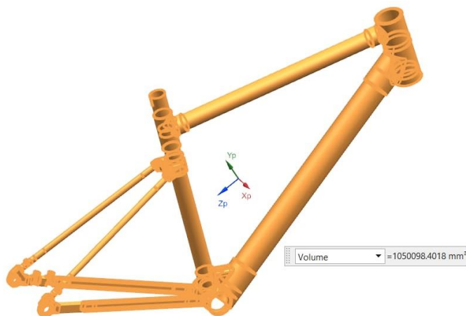
Figura 131.- Estimación del volumen del cuadro en aluminio.
