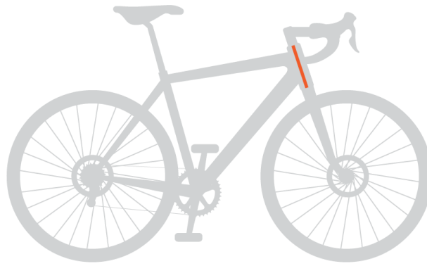
Figura 57- Longitud de la pipa de la dirección [115]
