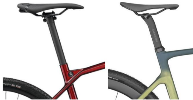
Figura 68- Comparación de abrazaderas: cuña (izq.) y abrazadera (der.) [120], [121]
