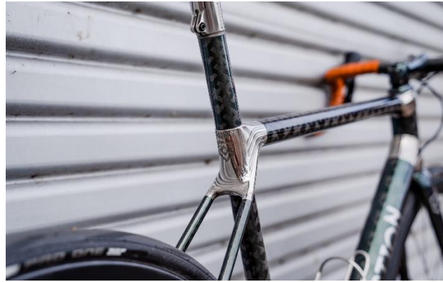
Figura 111: Ejemplo de bicicleta construida con racores[160].
