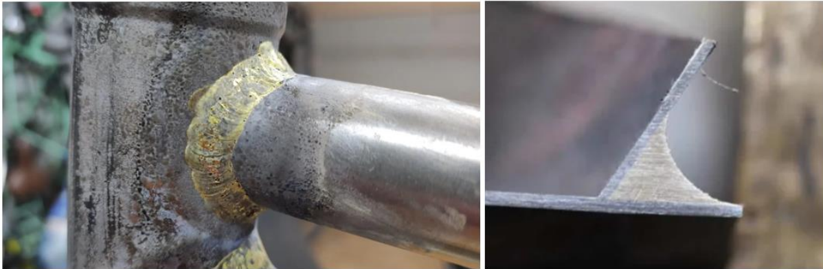
Figura 109- Ejemplo y resultado de soldadura fuerte[155]
