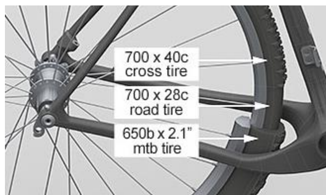
Figura 72- Diferentes tamaños de llanta y balón de neumático [126]
