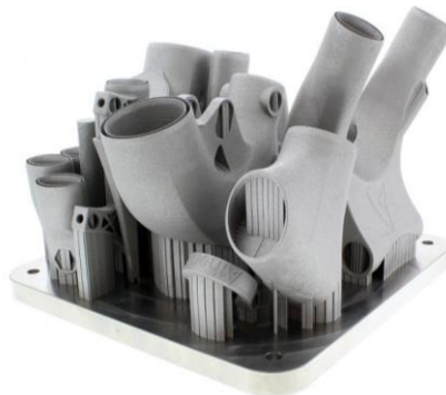
Figura 112- Muestra de racores elaborados por fabricación aditiva de titanio [161]
