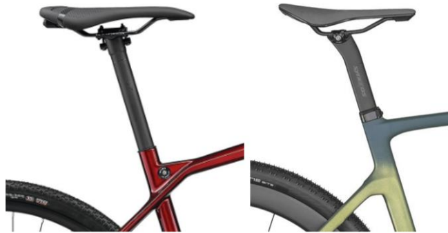
Figura 67- Comparación de tijas: tubular (izq.) y huella en D (der.) [120], [121]
