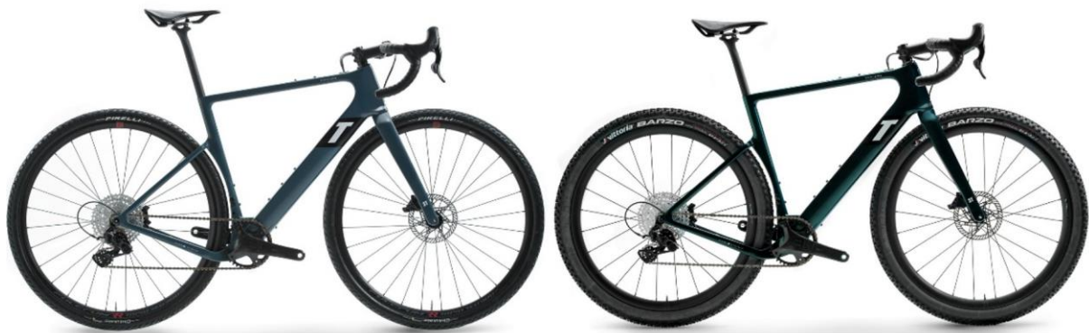
Figura 71 - Comparación de ruedas: 700C (izq.) y 650B (der.) [127]
