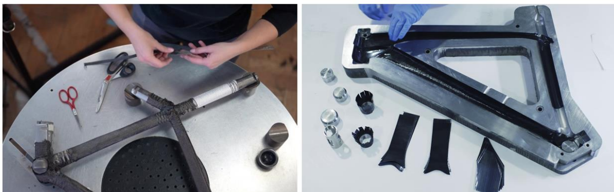
Figura 106- Tipos de molde para la fabricación de cuadros de carbono: cerrado (Izq.) y abierto (der.).
