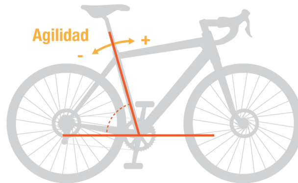
Figura 53- Ángulo del tubo del sillín [115]
