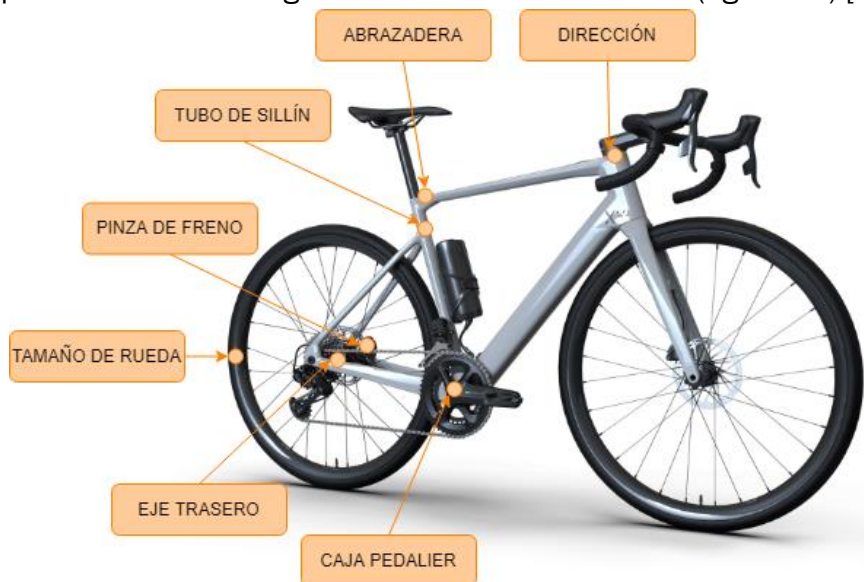
Figura 65- Representación de estándares dimensionales de un cuadro comercial [elaboración propia]
