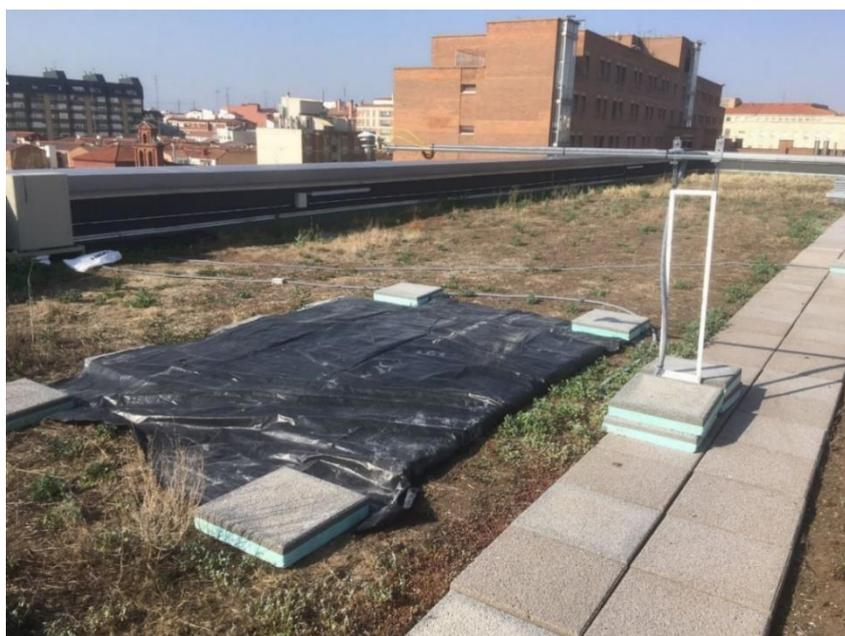
Figura 5.29 1- Medida del coeficiente de albedo de la superficie de plástico negro (*Elaboración propia*)
