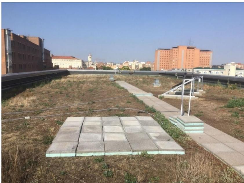
Figura 5.28 1- Medida del coeficiente de albedo de la superficie de baldosas imitación cemento (*Elaboración propia*)
