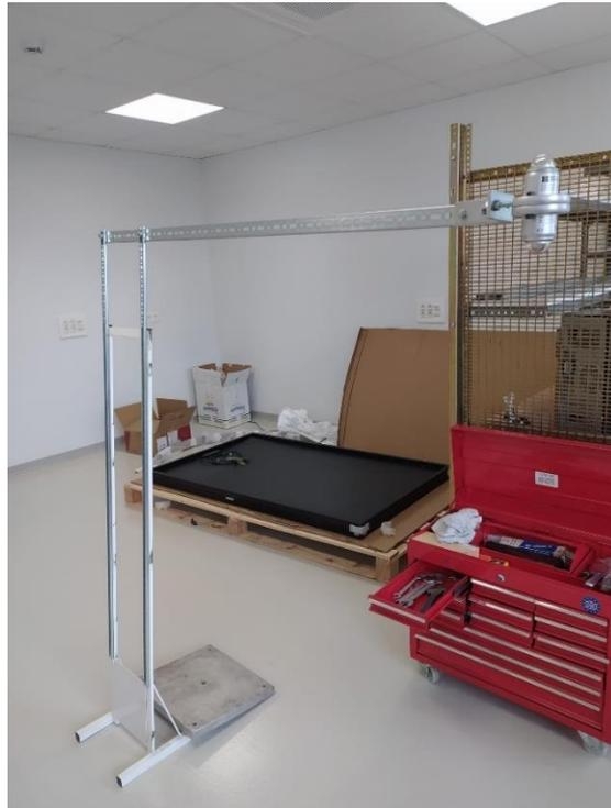
Figura 5.18 1 – Estructura soporte de aluminio para la medida de albedo (*Elaboración propia*)
