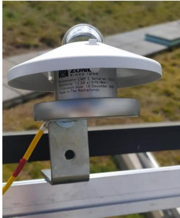
Figura 5.24 1 – Uno de los piranómetros con su constante de calibración
