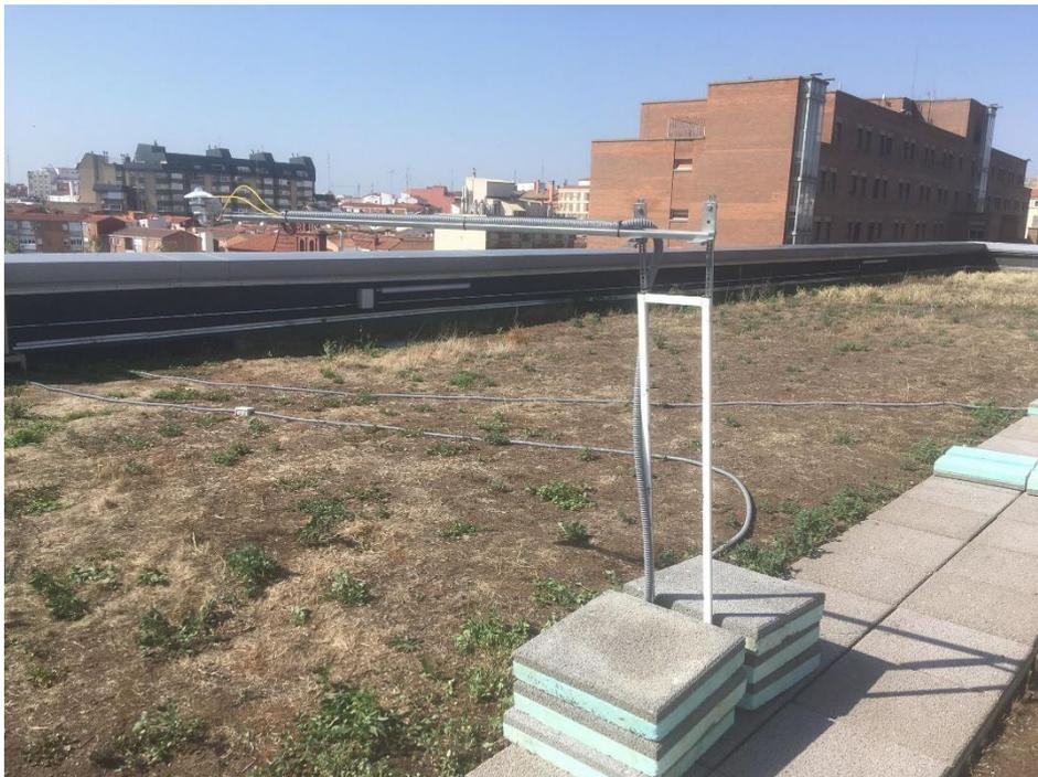
Figura 5.32 1- Medida del coeficiente de albedo de la superficie de la propia cubierta del edificio (*Elaboración propia*)
