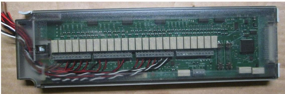
Figura 5.11 1 - Tarjeta multiplexora ya cableada (*Elaboración propia*)
