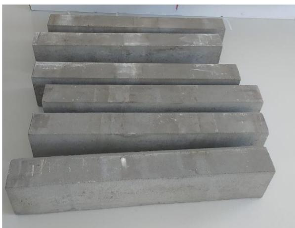
Figura 5.3 1 – Detalle de los bordillos de hormigón empleados como lastres (Elaboración propia)
