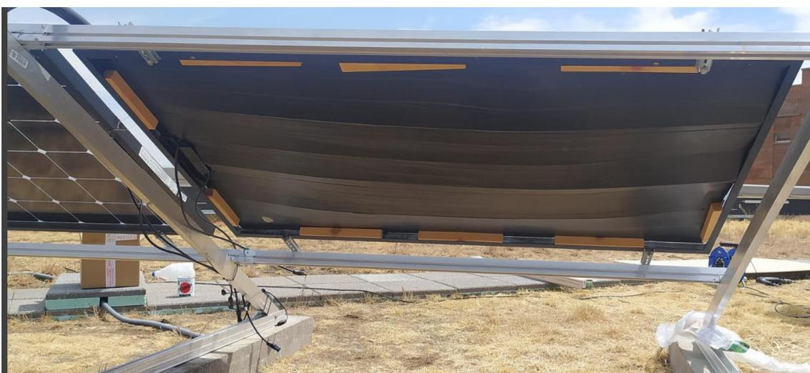
Figura 5.13 1 - Detalle del panel empleado como monofacial ya sombreado con el plástico
