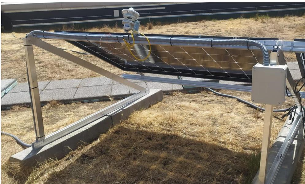
Figura 5.7 1 – Piranómetros y caja de conexiones sobre la estructura soporte *(Elaboración propia)*
