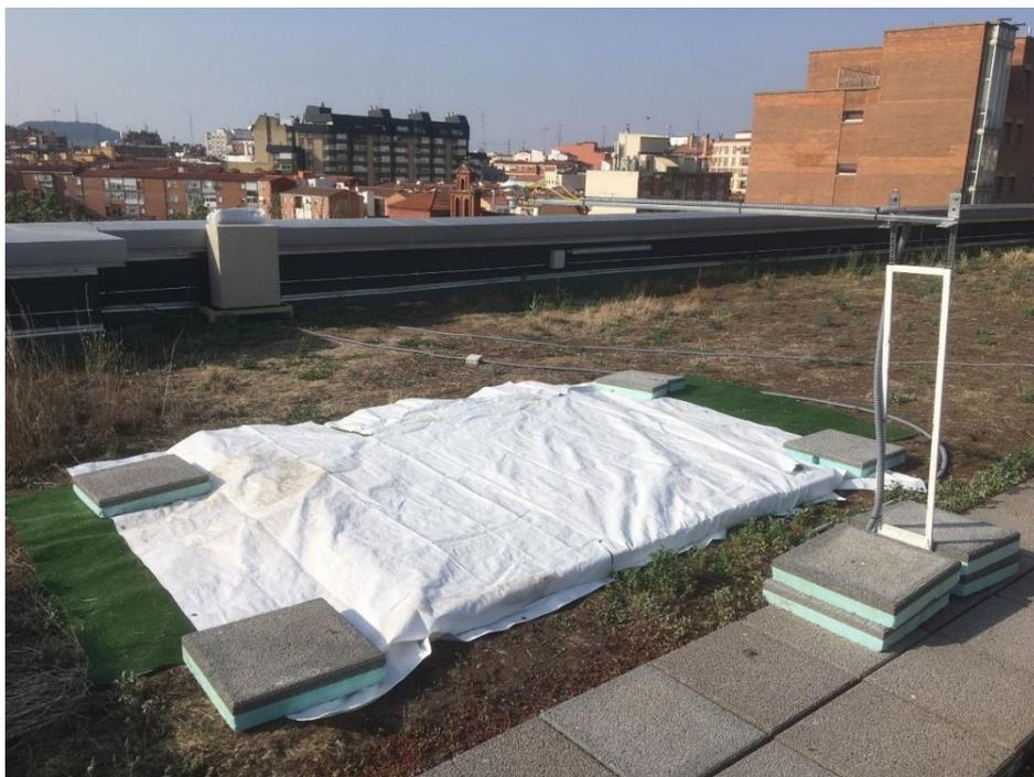
Figura 5.31 1- Medida del coeficiente de albedo de la superficie de lona de plástico blanco
