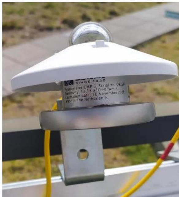
Figura 5.25 1 – Segundo piranómetro con su constante de calibración
