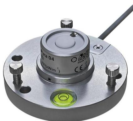
Figura 4.5.2 1- Piranómetro basado en el efecto fotovoltaico basado en un fotodiodo de silicio («*Piranómetro de Silicio*», s. f.)
