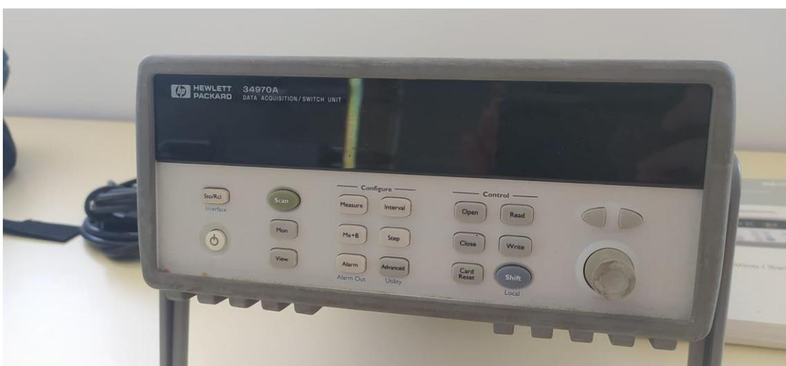
Figura 5.12 1 - Equipo de adquisición de datos (data logger) HP Agilent 34970 A empleado (*Elaboración propia*)
