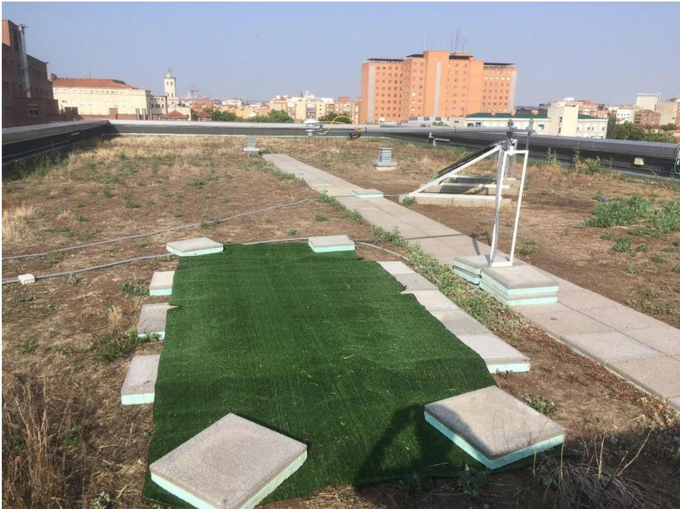
Figura 5.30 1- Medida del coeficiente de albedo de la superficie de césped artificial
