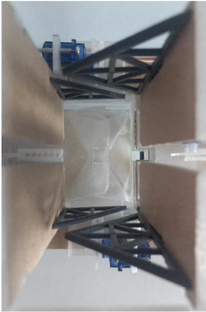
Figura 112. Tras retroceder los tres servomotores que se encargaron de los primeros tres pliegues, queda el espacio libre para que el jabón descienda.
