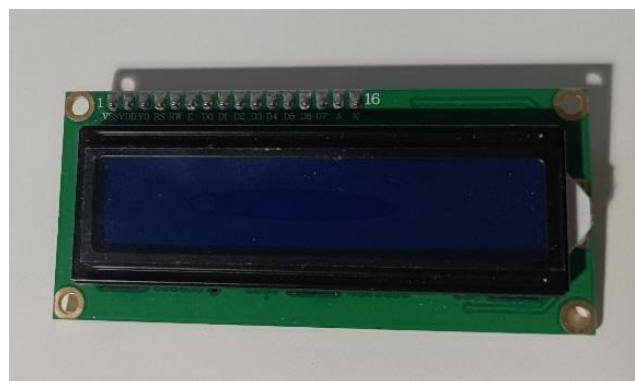
Figura 9. Display LCD, 2 filas, 16 columnas.
