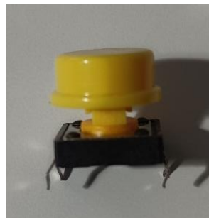
Figura 8. Pulsador normalmente abierto.
