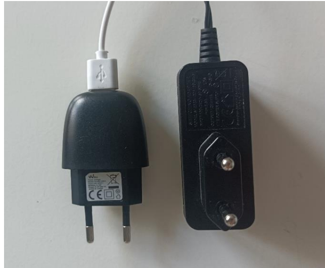
Figura 7. Fuentes de alimentación de 12 V y 5 V.
