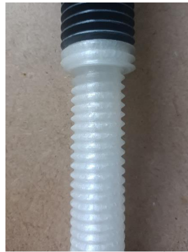
Figura 64. Rosca corregida, paso igual que la del eslabón 2.
