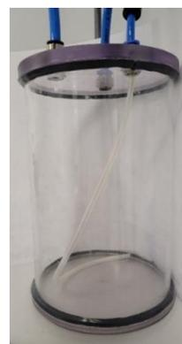
Figura 16. Cámara de mezcla
