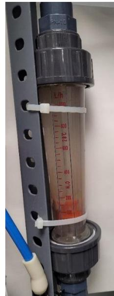
Figura 20. Rotámetro de plástico (L/h)
