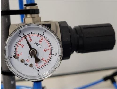
Figura 17. Manómetro (psi, bar)
