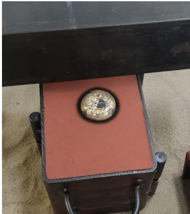
Figura 49. Colada directa con poliestireno de alto impacto. Fuente: Elaboración propia.
