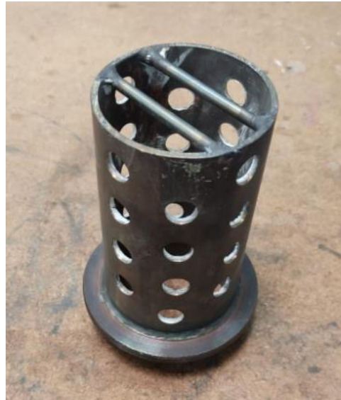
Figura 45. Cilindro utilizado para la fundición. Fuente: Elaboración propia
