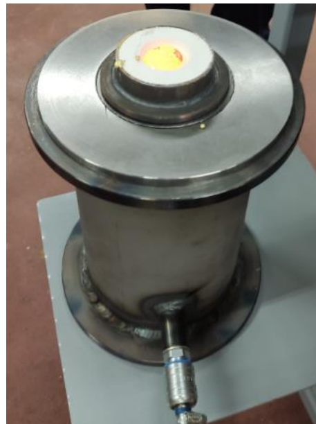
Figura 46. Útil para cilindros de fundición. Fuente: Elaboración propia.
