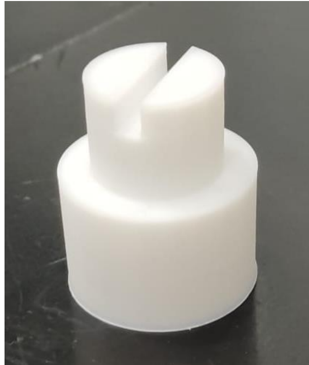
Figura 32. Modelo impreso con poliestireno de alto impacto. Fuente: Elaboración propia.
