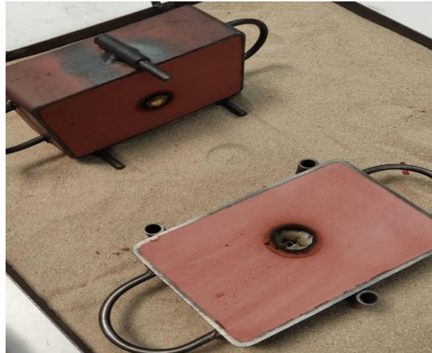
Figura 43. Semi cajas y arenas. Fuente: Elaboración propia
