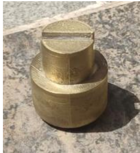
Figura 60. Cilindro fundido de Polycast. Fuente: Elaboración propia.
