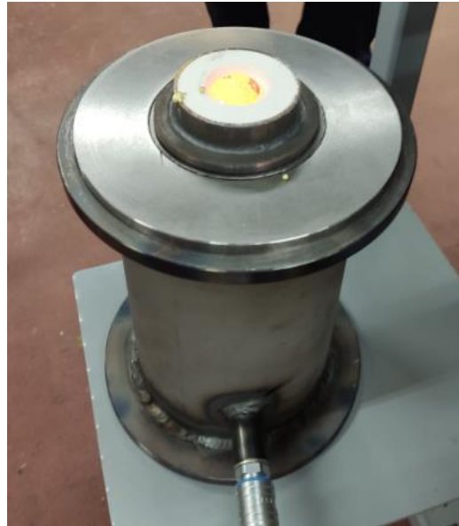
Figura 57. Latón ya vertido en el útil para cilindros, tras la realización del vacío. Fuente: Elaboración propia.
