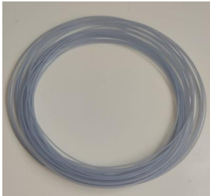
Figura 36. Bobina de MoldLay diámetro 1,75mm. Fuente: Elaboración propia.
