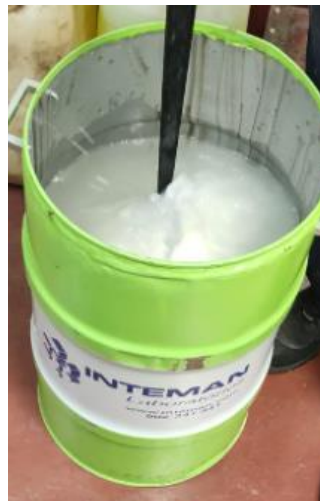
Figura 58. Bidón de agua con el cilindro de fundición sumergido. Fuente: Elaboración propia.
