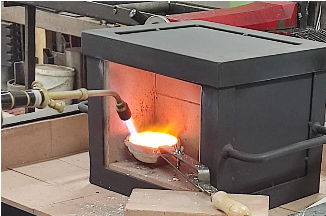
Figura 42. Fusión del latón con acetileno. Fuente: Elaboración propia.
