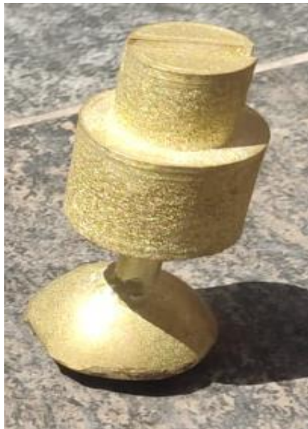
Figura 59. Cilindro fundido de Moldlay. Fuente: Elaboración propia.
