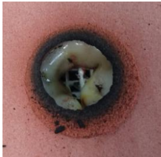
Figura 50. Modelo de poliestireno de alto impacto en la semi caja tras la fundición. Fuente: Elaboración propia.
