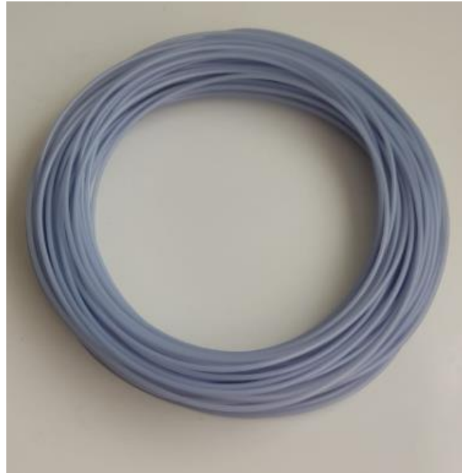
Figura 35. Bobina de Moldlay de 2,85mm de diámetro. Fuente: Elaboración propia.
