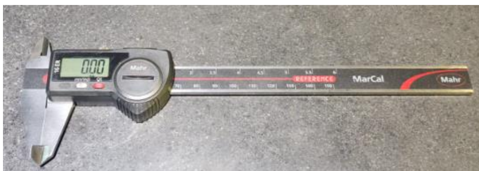
Figura 33. Calibre digital 0-150 mm. Fuente: Elaboración propia.
