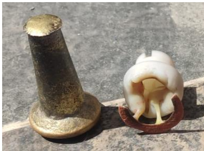
Figura 51. Bebedero y modelo de poliestireno de alto impacto. Fuente: Elaboración propia.
