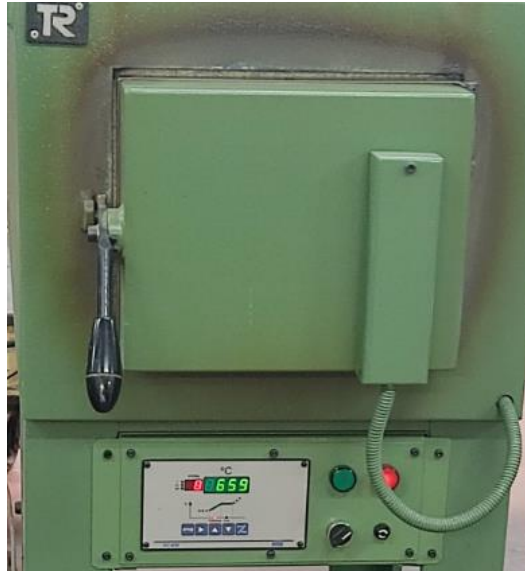
Figura 55. Horno del taller de fabricación realizando el quemado de los modelos. Fuente: Elaboración propia.
