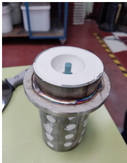
Figura 54. Cilindro de fundición completo con revestimiento. Fuente: Elaboración propia.
