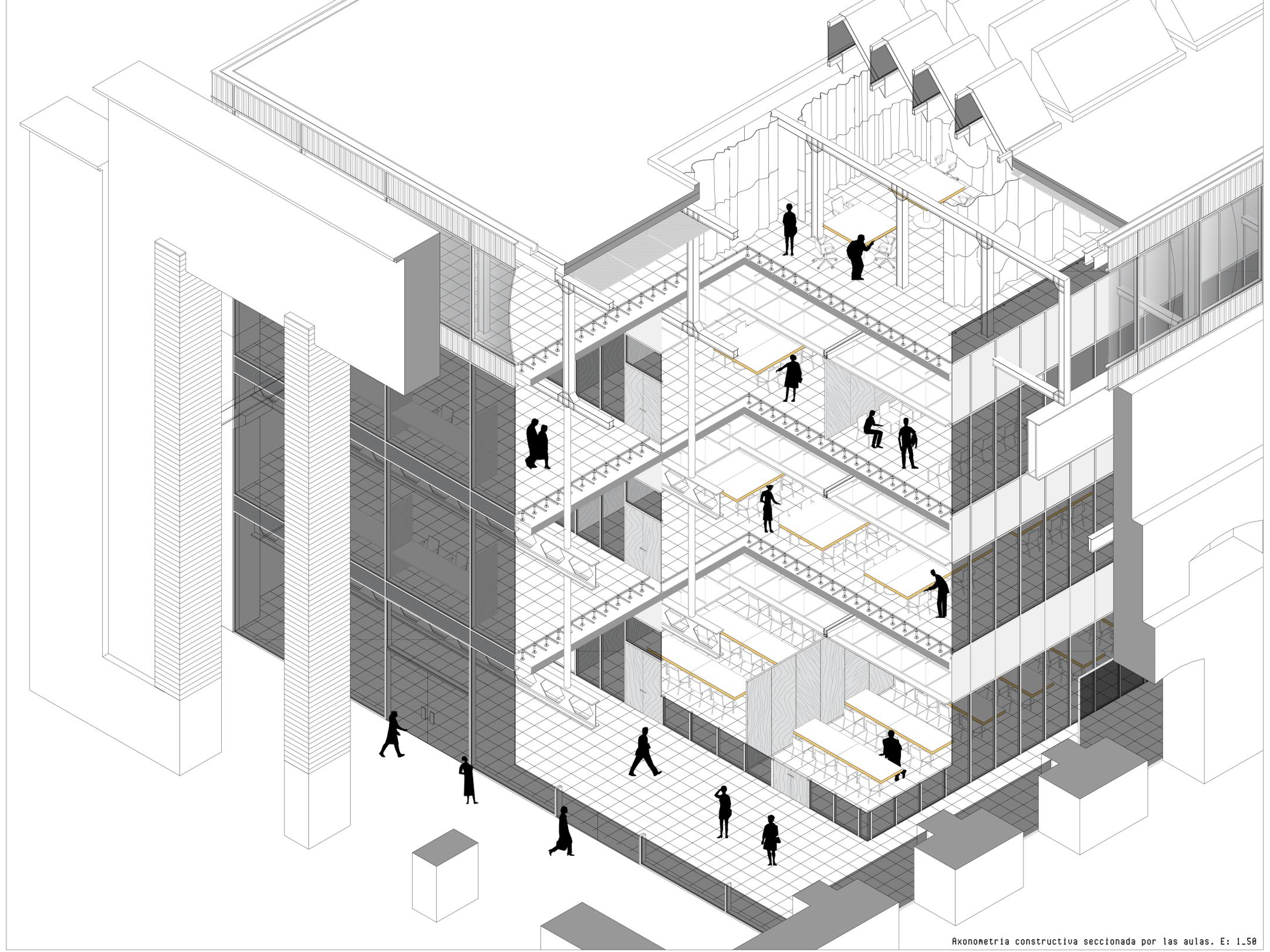
Axonometría constructiva seccionada por las aulas. E: 1:50
