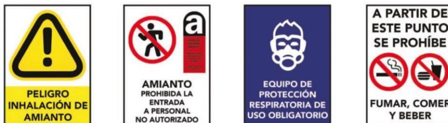
Figura 4. Señalización de zona de almacenamiento de residuos con amianto. Extraído del Instituto Nacional de Seguridad y Salud en el Trabajo (INSST 2023d).
