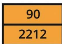
Figura 7. Ejemplo de señalización para unidad de transporte de mercancías peligrosas, en la que se indica el número de identificación de peligro 90 “Materia peligrosa desde el punto de vista medioambiental, materias peligrosas diversas”, y el n° ONU: 2590 (asbestos crisotilo) o 2212 (asbestos anfíbol). Extraído del Instituto Nacional de Seguridad y Salud en el Trabajo (INSST 2023g).
