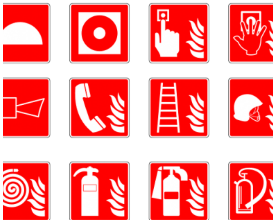
Figura 6. Señales relativas a los equipos de lucha contra incendios. (3)
