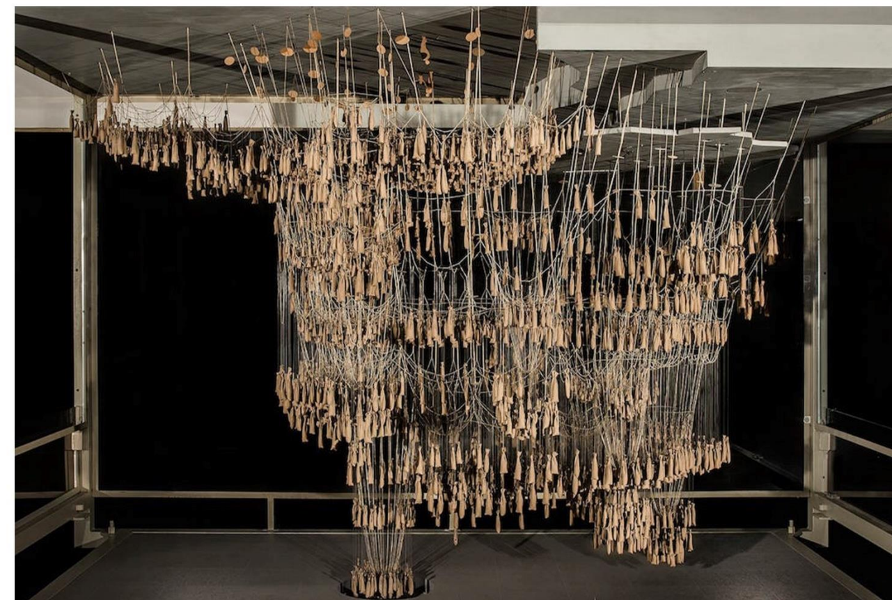
Fig. 51: Antoni Gaudí: Maqueta invertida de la Cripta e Iglesia de la Colonia Güell. E.1/15; uso de la catenaria y arcos funiculares Barcelona. S. XIX-XX
