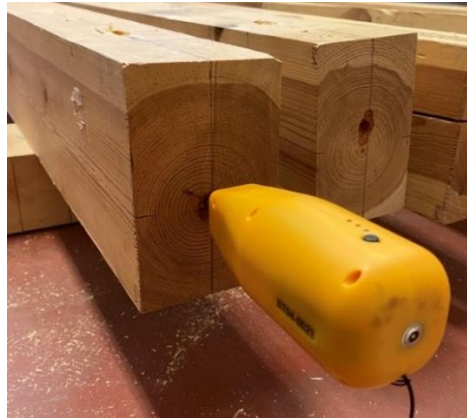
Ilustración 17: Palpador emisor del equipo Sylvatest para medición directa.
