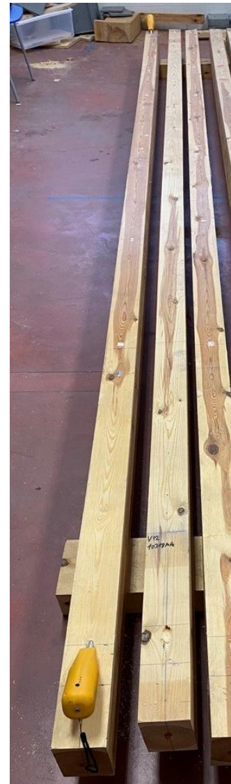
Ilustración 25: Palpadores en posición para medición indirecta con el equipo Sylvatest.
