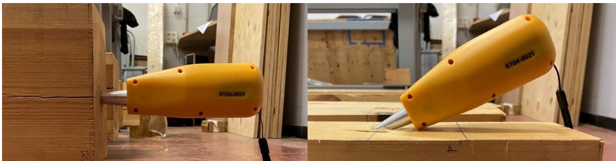
Ilustración 28: Colocación de los palpadores del equipo Sylvatest para mediciones directas (izquierda) y para mediciones indirectas (derecha).
