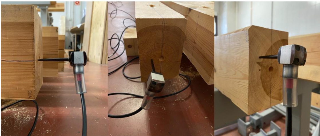
Ilustración 31: Sensor emisor del equipo MicroSecond Timer clavado para medidas directas.
