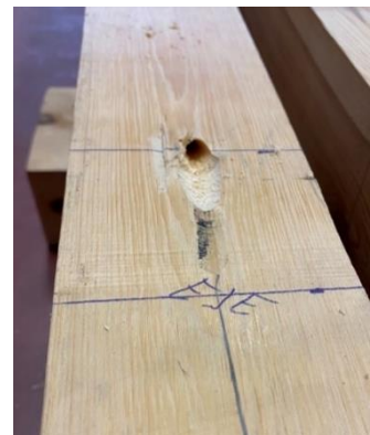
Ilustración 26: Orificio para medición indirecta con el equipo Sylvatest.
