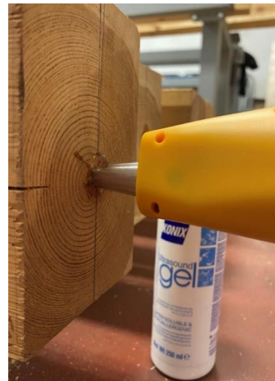
Ilustración 29: Medición directa con gel con el equipo Sylvatest.
