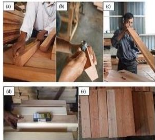
Ilustración 4: Proceso de clasificación visual: a) medición del espécimen, b) identificación de la especie del espécimen, c) comprobación de los defectos, d) comprobación del contenido de humedad, e) clasificación de la muestra. Fuente: (Mokhtarruddin et al., 2016).
