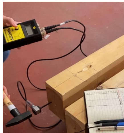
Ilustración 18: Equipo MST durante la medición directa de una viga.
