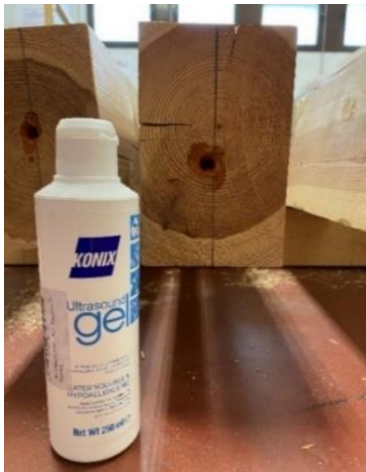
Ilustración 20: Gel de acoplamiento KONIX tras su aplicación y una medición directa.
