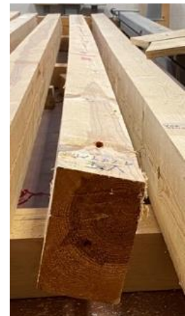
Ilustración 11: Viga nº4 alabeada.
