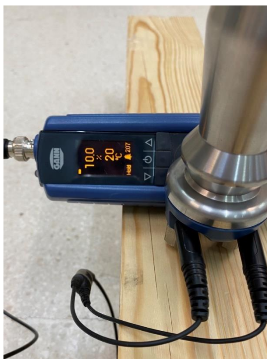
Ilustración 23: Uso del Hydromette BL A plus para la estimación del contenido de humedad de una probeta testigo.
