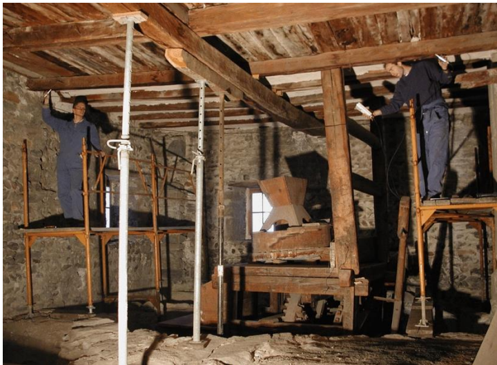
Ilustración 8: Aplicación de una medición longitudinal indirecta con el Sylvatest-Duo: estudio en un castillo del siglo XIII, Sion, Suiza. Fuente: https://shorturl.at/tLPRY
