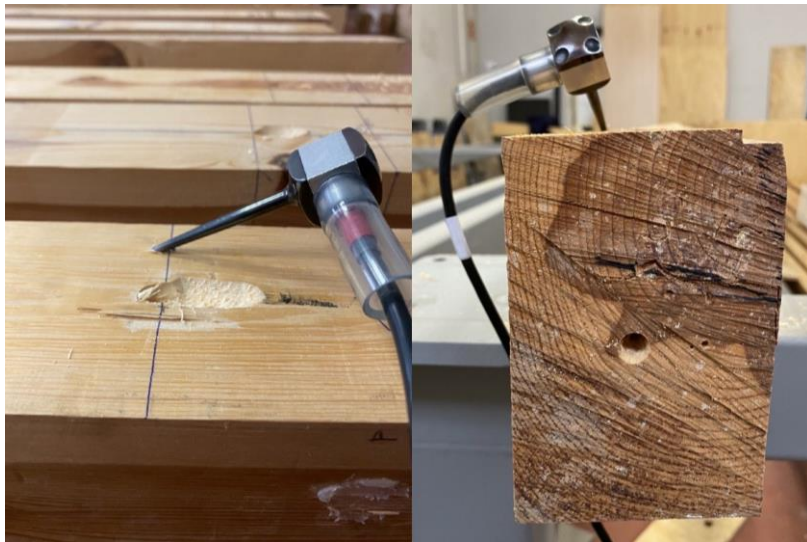
Ilustración 32: Sensor emisor del equipo MST clavado para medida indirecta (izquierda). Sensor receptor del equipo MST clavado para medida indirecta (derecha).
