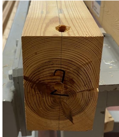
Ilustración 27: Orificios realizados en la viga n°9 para las mediciones directas e indirectas con el equipo Sylvatest.
