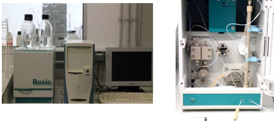
Fig. 3.4. Cromatógrafo iónico empleado en la determinación de aniones
