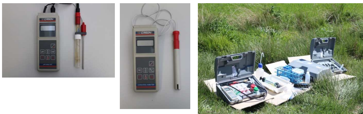
Fig. 3.2. Sondas de campo para medidas de pH, ORP y EC in situ
