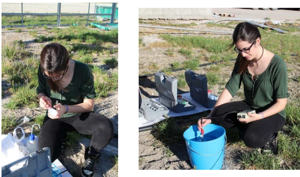
Fig. 3.3. Procedimiento de toma de muestra y medida de parámetros físico-químicos in situ
