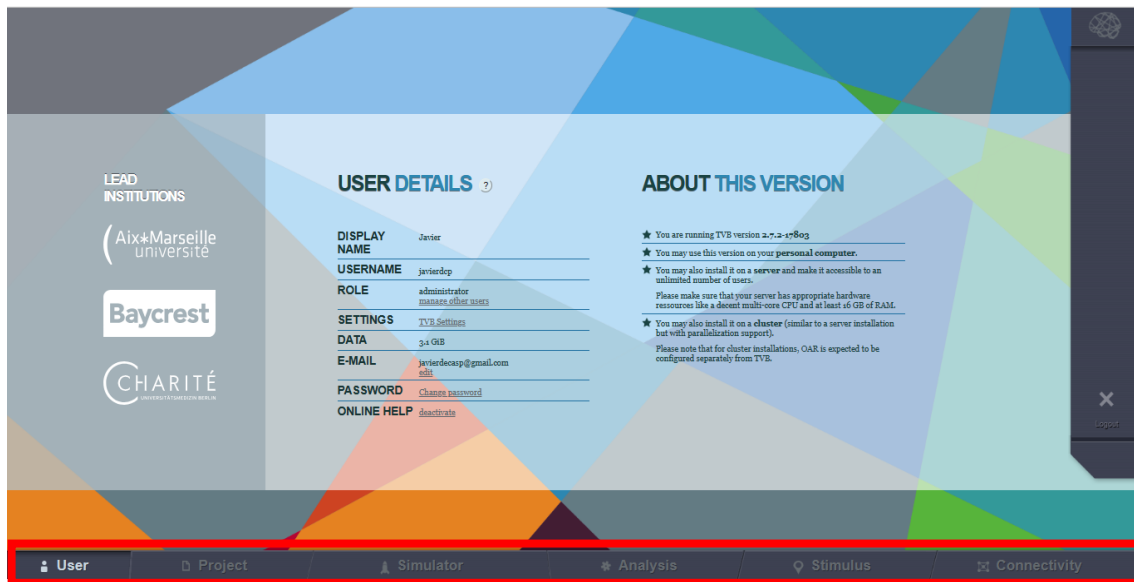
Figura 5.1. Pantalla de usuario de TVB. Se resalta dentro del cuadrado rojo las seis secciones distintas en las que se divide la GUI.
