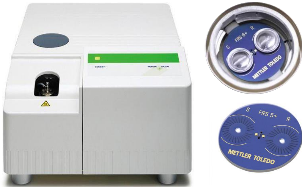
Figura 14. Aparato de DSC utilizado para realizar las pruebas junto con una imagen (a la derecha) de los espacios reservados para colocar la muestra y la referencia.
