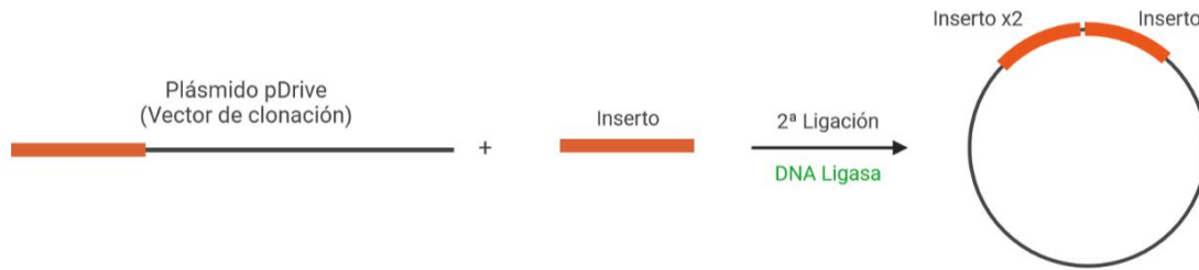
Figura 31. Esquema de la segunda ligación del inserto inicial con el pDrive+Inserto linealizado
