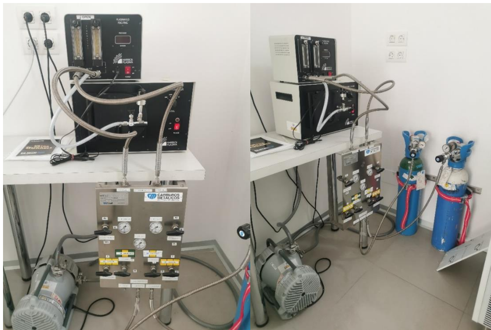
Figura 18. Equipo completo utilizado para la activación de superficies: Harrick Plasma Cleaner PDC-002, bomba y bombonas de los gases
