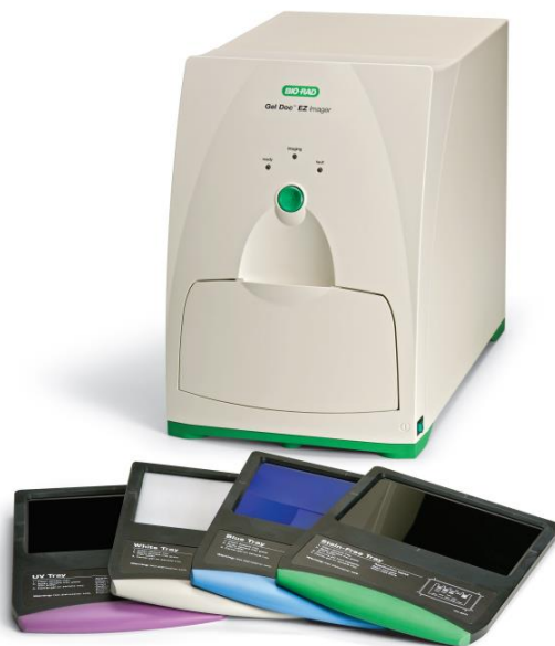
Figura 16. Equipo Gel Doc EZ Imager de la casa BIO-RAD, para analizar los geles de electroforesis
