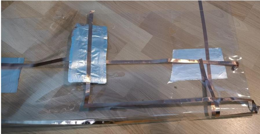
*Ilustración 10. Realización del circuito trasero.*
