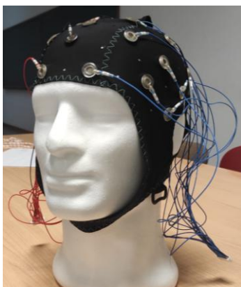
Ilustración 1 Dispositivo EPOC Flex (Emotiv, San Francisco) utilizado para recoger la señal EEG
