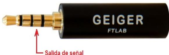
**Figura 2.10.** Sensor externo de radiaciones ionizantes para Smartphone.
