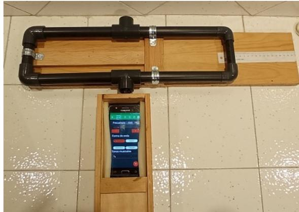
**Figura 3.** Dispositivo de medida de la velocidad del sonido por interferometría.
