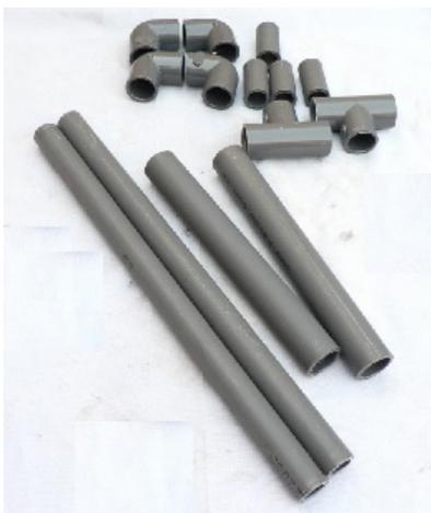
**Figura 2.7.** Despiece del interferómetro de Quincke casero.
