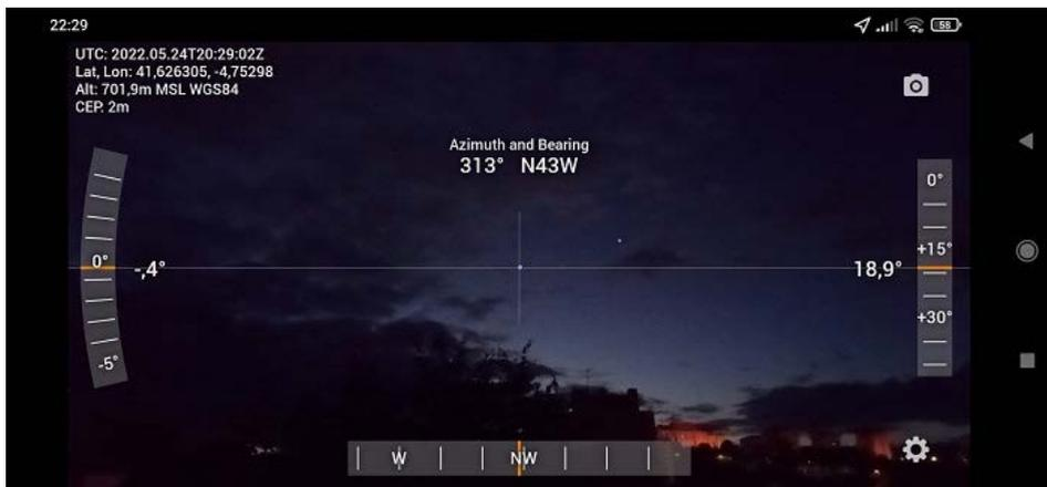
**Figura 3.6.** La retícula de *Dioptra* permite una excelente alineación del móvil con el objeto y es particularmente útil en las determinaciones astronómicas.
