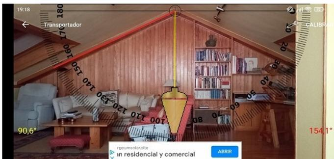
**Figura 3.23.** Para medir inclinaciones con la cámara se señala con el dedo la línea roja adyacente al plano inclinado. El ángulo se lee en el semicírculo graduado o en la esquina inferior derecha ( $154-90=64^\circ$ ).
