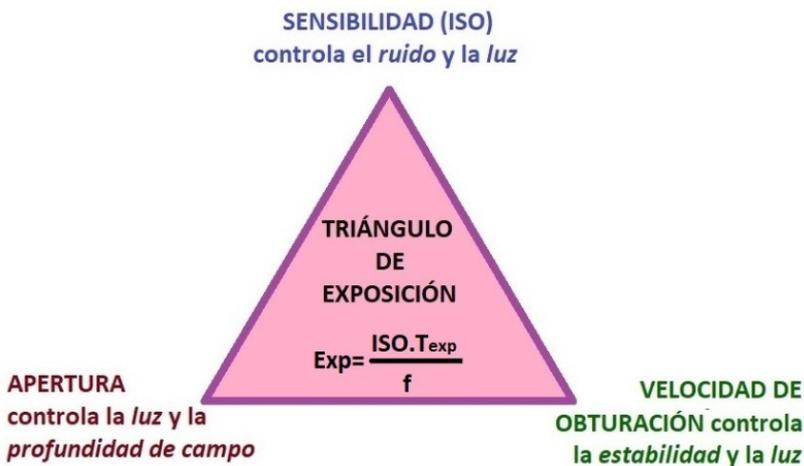
**Figura 1.** El grado de exposición de una fotografía es el resultante de la combinación de la *sensibilidad* del receptor, de la *apertura* del diafragma y de la *velocidad de obturación*.
