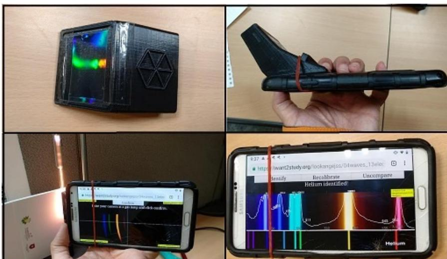
Figura 3.4. El Smartphone equipado como espectrofotómetro.
