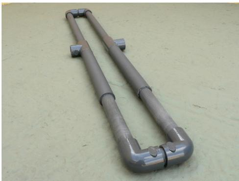
**Figura 2.6.** Tubos de Quincke caseros contruidos con tubería de PVC.
