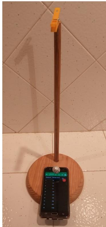
**Figura 1.** Dispositivo para la medida del período de un péndulo.
