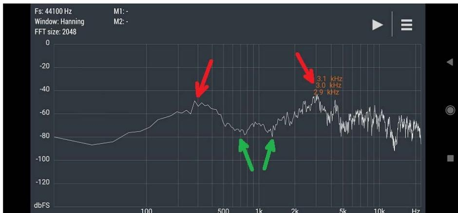
**Figura 3.** Análisis espectral del sonido /i/ del habla castellana realizado con *Spectrun Analyzer Pro*. En color rojo se señalan los formantes aditivos con frecuencias de 300 y 3 000 Hz y en color verde los formantes sustractivos en la banda de frecuencias comprendida entre 700 y 1 400 hz.
