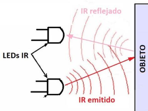
Figura 17. Esquema del funcionamiento del sensor de proximidad.
