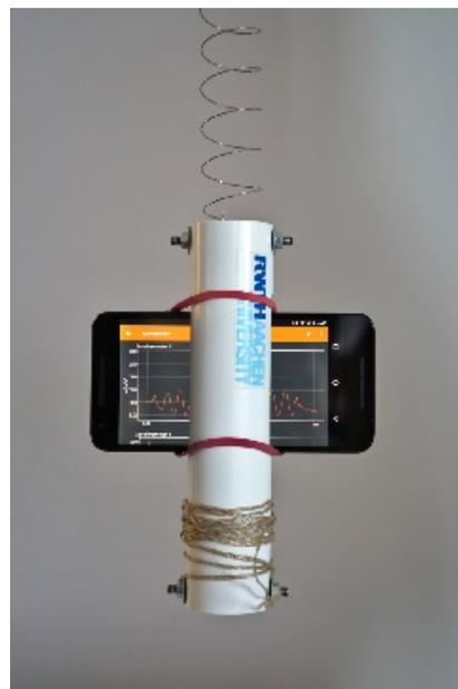
**Figura 3.18.** Montaje del teléfono como oscilador lineal.
