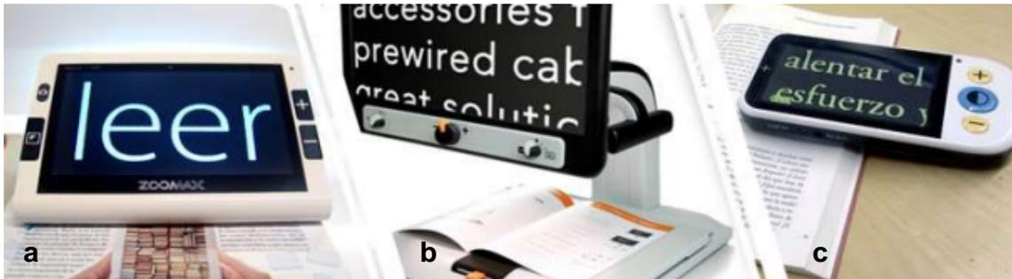
*Figura 4: Ayudas electrónicas para visión próxima. a) lupa electrónica b) Lupatelevisión c) lupa electrónica compacta (6).*
