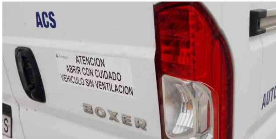
Figura 2. Ejemplo de señalización de ausencia de ventilación en un vehículo de transporte de refrigerantes.
