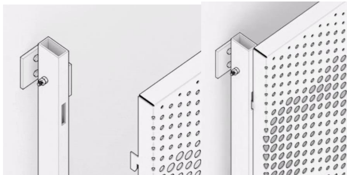
Sistema constructivo de la colocación de paneles de chapa perforada
