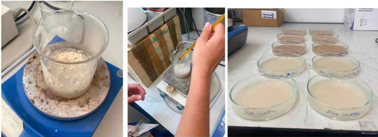
Figura 9. Experimentación en los labs CellMat – Preparación de los films con proteína de soja
