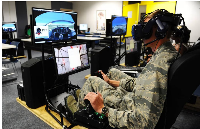
Figura 2.4: Cadete utiliza un sistema de RV para practicar habilidades de vuelo. Fuente [12]
