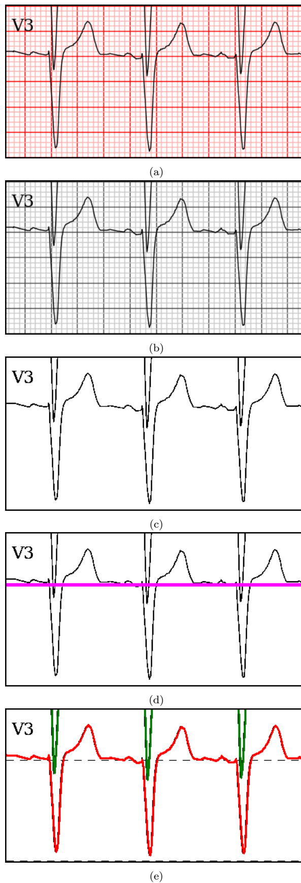
Figura 4.12: Secuencia de transformación de un recorte de una derivación a lo largo de la digitalización: (a) derivación de ECG recortada, (b) conversión a escala de grises, (c) binarización (blanco/negro), (d) ROI identificada y resaltada en magenta, (e) señal de la derivación digitalizada resaltada en rojo (parte de otra derivación detectada arriba resaltada en verde).
