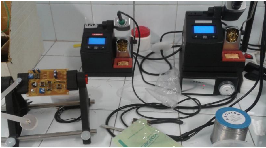
Figura 27– Material de trabajo usado en la construcción de la placa del calibrador.
