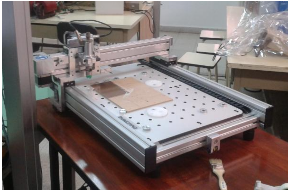
Figura 43 – La máquina Bungard CCD en pleno proceso de funcionamiento.
