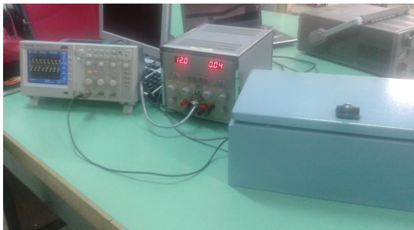
Figura 30– Conexión de la fuente de alimentación, calibrador y osciloscopio.
