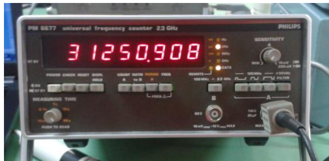
Figura 38 – Captura del frecuencímetro en funcionamiento.
