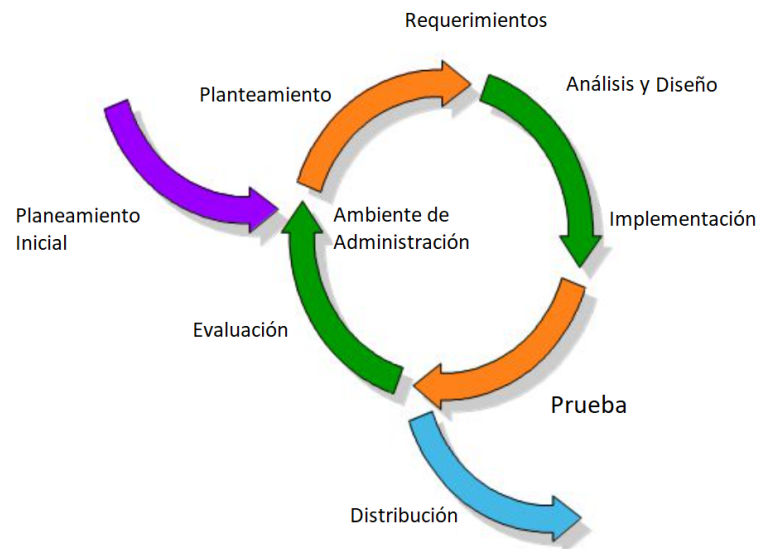
Figura 1.1: Esquema de un desarrollo iterativo e incremental [6]
