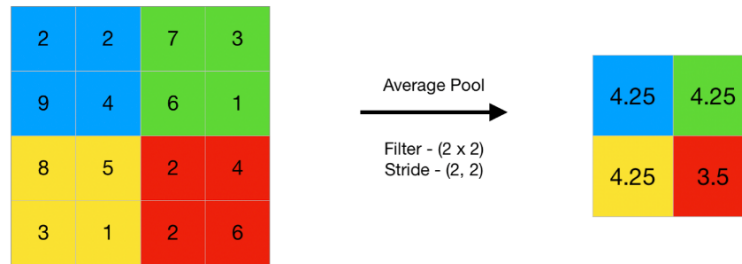
Figura 3.13: Average Pooling 2 \times 2 . Fuente: [27].
