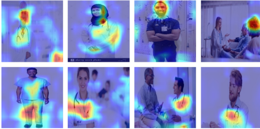
Figura 3.18: Ejemplificación de Grad-CAM aplicado a un modelo sesgado y otro no sesgado. Fuente [31]
