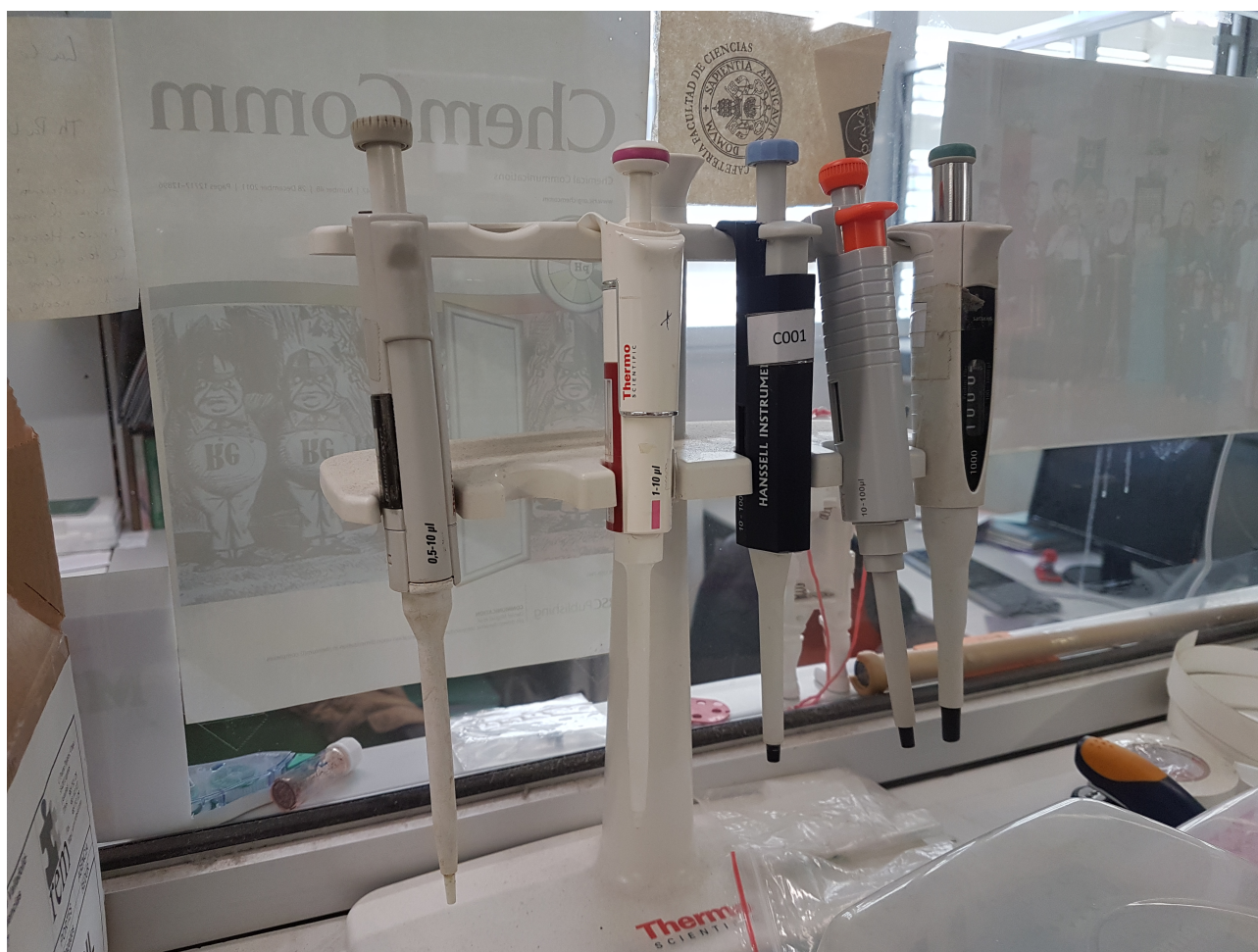
Figura 5.5: Soporte con diversas micropipetas monocanal de volumen variable en un laboratorio de química.
