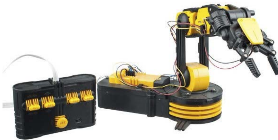
Figura 17: Brazo robot Velleman KSR10 y su unidad de control remoto
