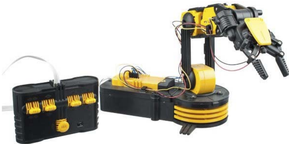
Figura 1: Brazo robot Velleman KSR10 y su unidad de control remoto
