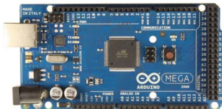
Figura 15: Placa de Arduino Mega 2560
