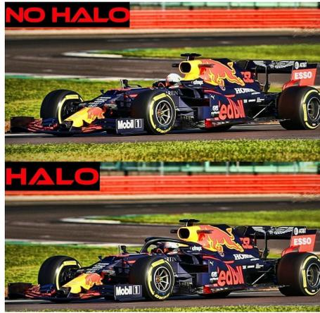
Figura 2.13: Arriba monoplaza de F1 sin halo y debajo monoplaza de F1 con halo
