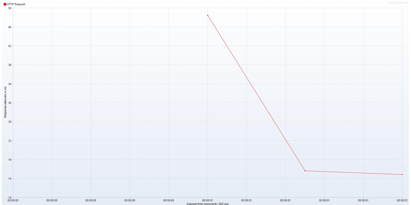
Figura 7.4: Evolución de la latencia en resolución de las peticiones desde 0 hasta 100 usuarios. Eje X medido en hh:mm:ss y eje Y medido en milisegundos.
