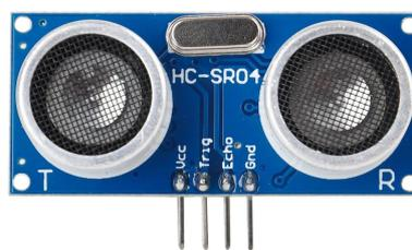
Figura 2.4: Imagen del Sensor HC-SR04 con sus 4 pines observables
