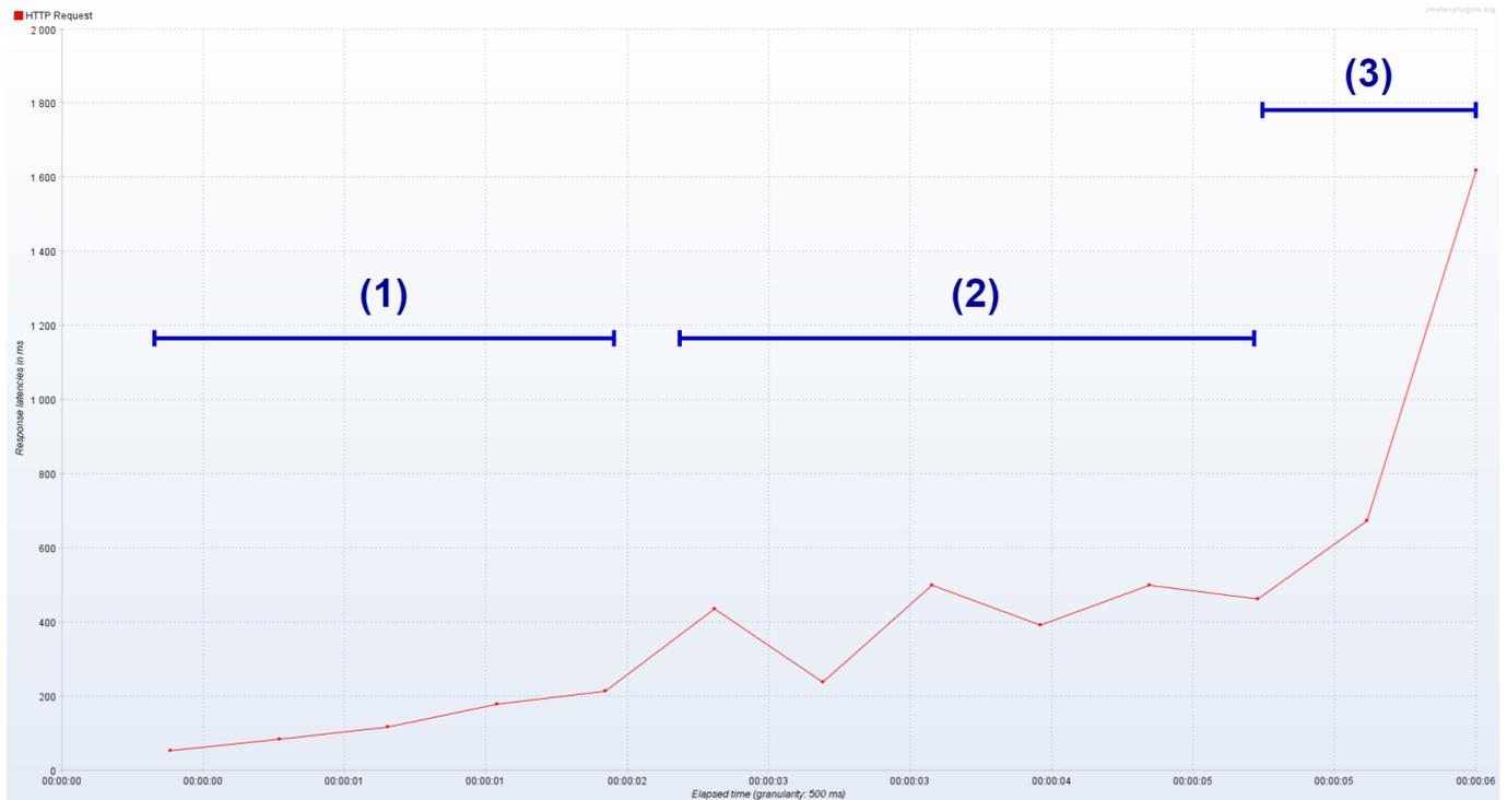
Figura 7.6: Evolución de la latencia en resolución de las peticiones desde 0 hasta 15000 usuarios. Eje X medido en hh:mm:ss y eje Y medido en milisegundos. La zona (1) delimita desde 0 hasta el segundo 2, zona (2) desde el 2 al segundo 5 y zona (3) del segundo 5 al final de la prueba.
