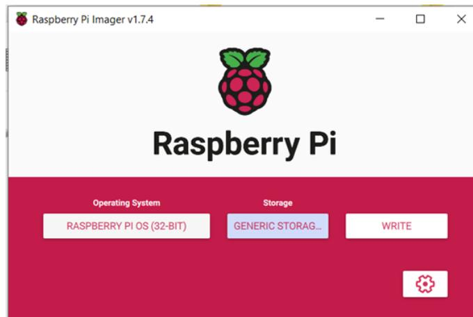
Figura 5.1: Interfaz principal de la aplicación de instalación de sistemas operativos Raspberry Pi: `imager`.
