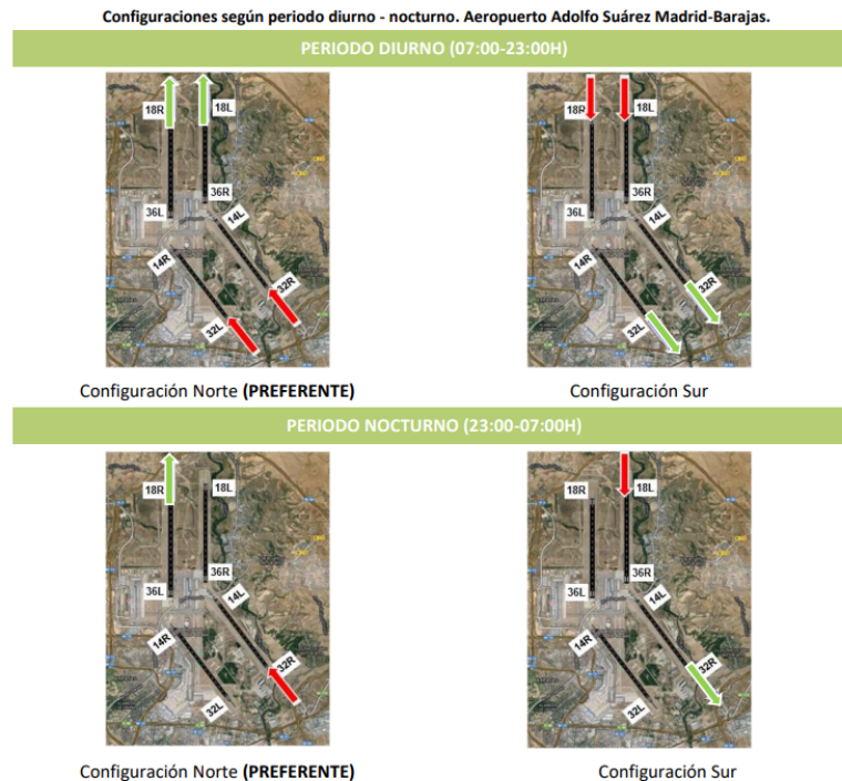
Figura 3.8: Esquema de las posibles configuraciones de pistas, extraído de [22]
