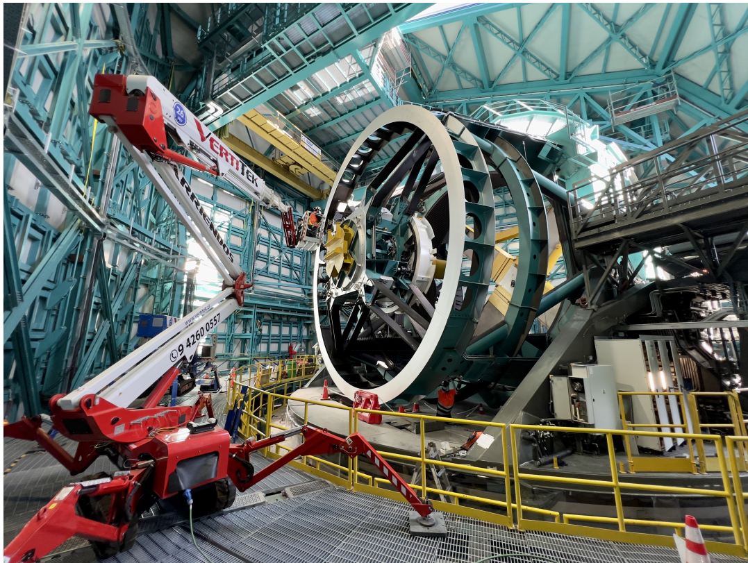
Figura 3.6: Montaje del Simonyi Survey Telescope dentro del Observatorio Vera C. Rubin [27]. Es un telescopio sinóptico que, al contrario que el Euclid, se encuentra en tierra.
