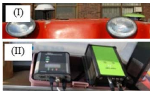
Figura 3.11. Colocación de las antenas (I) y los receptores (II)
