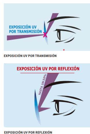
Figura 12. Exposición a luz UV por reflexión y por transmisión [11].
