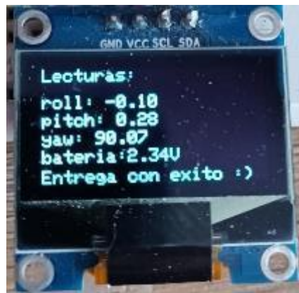
Figura 92. Pantalla OLED con la inclinación de 90 grados en el yaw.
