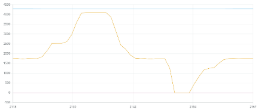
Figura 89. Voltaje de salida del joystick de yaw (línea amarilla).
