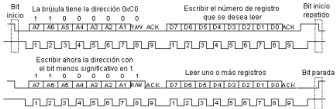
Figura 19. Funcionamiento protocolo I2C (Eduardo J.Carletti, 2023).
