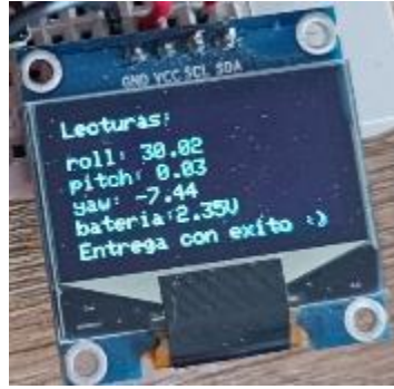
Figura 90. Pantalla OLED con la inclinación de 30 grados en el eje de roll.
