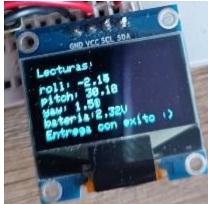
Figura 91. Pantalla OLED con la inclinación de 30 grados en el eje de pitch.
