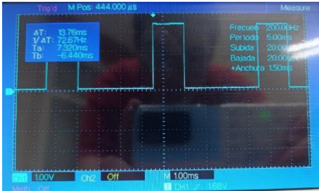
Figura 85. Señal PWM para el funcionamiento de los motores.
